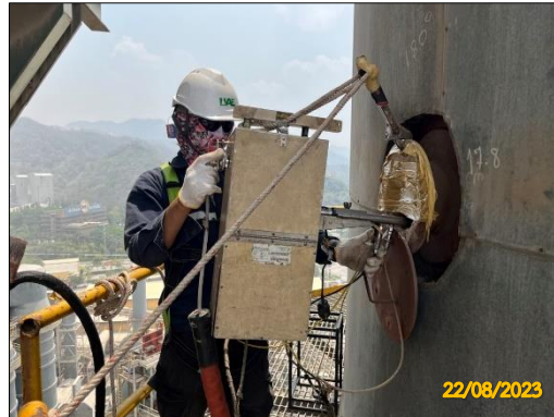
รูปที่ 3-12 การตรวจวัดคุณภาพอากาศ จากปล่องของโรงงานปูนฯ บริเวณ Main Stack ของสายการผลิตที่ 4
